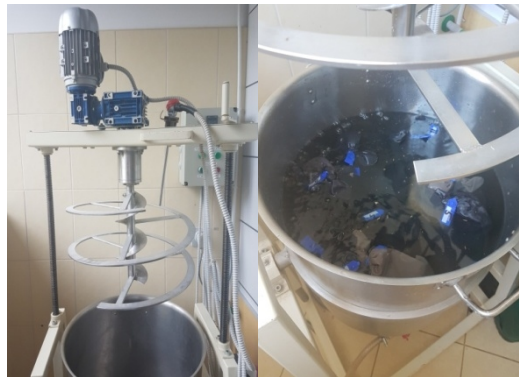
b. Próby zostały zamoczone w kotle mikrośłodowni na 20 godzin przy ciągłym napowietrzaniu
